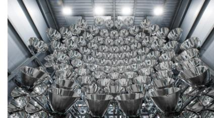
**2014–2018: „MHLS“ (NRW MULNV, BMWi):** Bau des „Modularen Hochleistungsstrahlers Jülich“ und erste Versuche mit einem 250-kW-Reaktor zur thermochemischen Wasserstoffherzeugung
